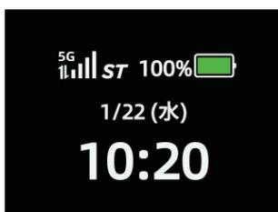
画面に日時（曜日）、接続ネットワーク、電波受信レベル、接続状態、電池残量などの情報が表示され、30 秒ごとに表示位置が切り替わります。
